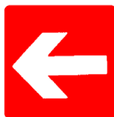
Chemin vers un matériel de lutte contre l'incendie
